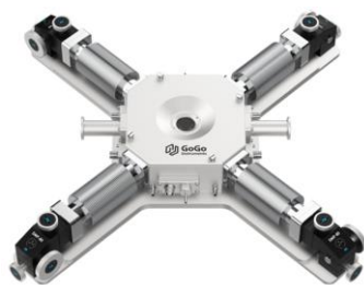
C 位移台调节 液氮致冷，电阻加热
